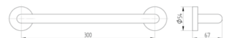
200 3030 010 Wannengriff 300 mm beim Kleben auf Klebekraft achten Hinweis s. Seite 84 bath grab bar 300 mm
