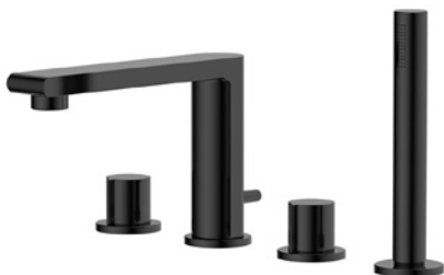
230 6170 040 Wanne-Brause-Batterie 4-Loch mit Brause mit Keramik-Innenoberteilen 90 mit Auslauf und Umstellung eigensicher gegen Rückfließen Ventil Kaltwasser linksschließend Ventil Warmwasser rechtsschließend Montageplatte und Montagegestell s. Seite 19 bath-shower mixer
